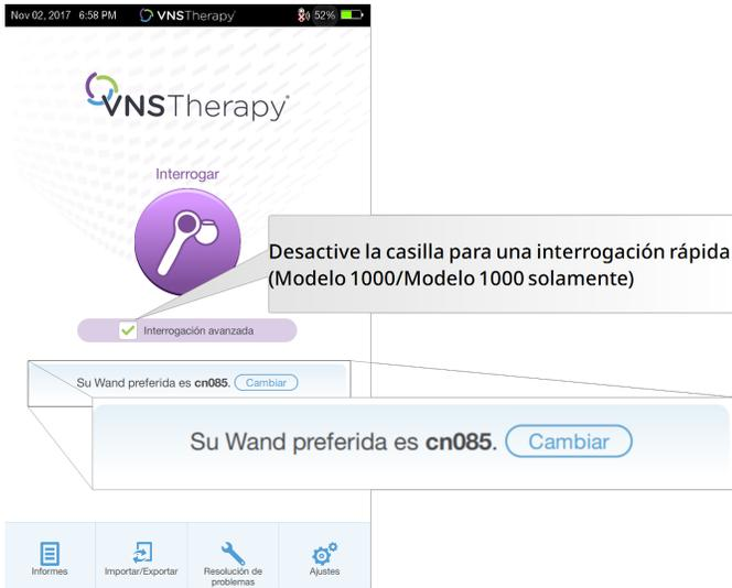
Una vez que el Programmer y la Wand estén conectados, coloque la Wand sobre el generador para finalizar la interrogación. Una vez finalizada la interrogación, el software muestra la [«Pantalla de resumen» en la página 41.](#)
